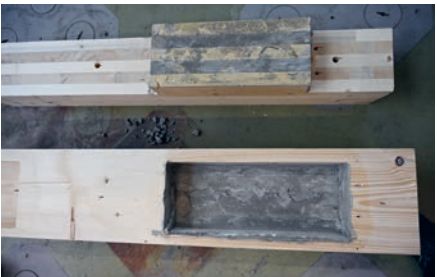
Les mortaises de cisaillement ont été remplies d'un composé à base de ciment
