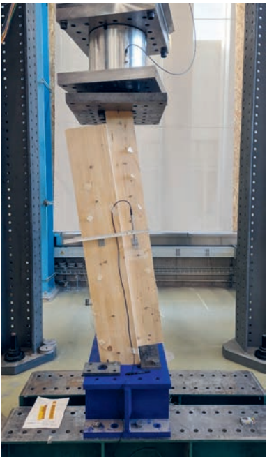
Comportement ductile du tenon de cisaillement de l'élément CLT
