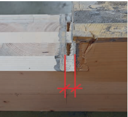
Comportement ductile du tenon de cisaillement de l'élément CLT
