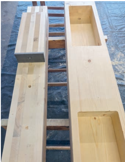
Les mortaises de cisaillement ont été remplies d'un composé à base de ciment
