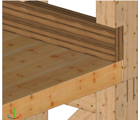
Visualisierung Cadwork - Unterstützung auf Traversen
