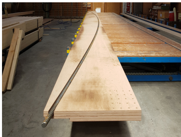
En détail : barre de précontrainte fraisée en forme de ventre de poisson dans la poutre en hêtre
