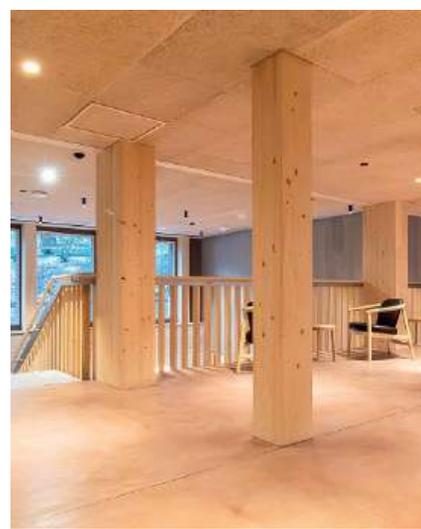
Ein durchdachtes Konstruktions- und Brandschutzkonzept war die Grundlage für einen wirtschaftlichen Pflegebau mit tragenden Holzstützen und sichtbaren Holzdecken. Vom Tragwerk mit Holzstützen, Unterzügen, Wand und Deckenelementen bis hin zur Fassadenbekleidung: Fassade bis hin zu Vorhangbrettern und Handläufen: Regionales Holz sorgt für Behaglich-
